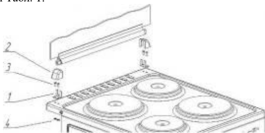
Рис. 6. Установка стеклянной крышки стола.
