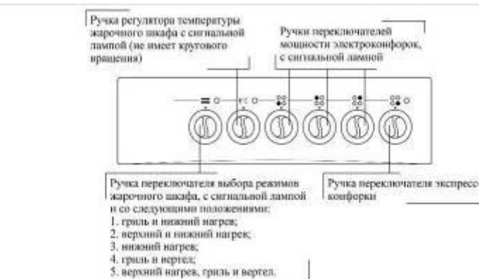
Рис. 12. Передняя панель плиты ЭП4/1э03МС, ЭП4/1э03М2С
