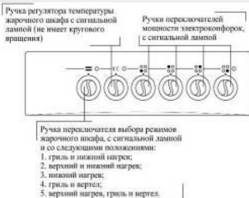
Рис. 10. Передняя панель плиты ЭП403МС, ЭП403М2С
